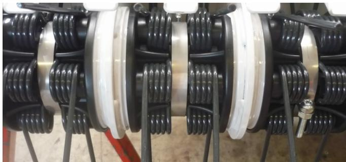
Pick-up Doppellagerung & Anti-loss System: Eine Schraube befestigt sechs Pick-up Zinken
