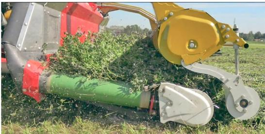
Das Funktionsprinzip aus kleiner ungesteuerter Pick-up, Rollenniederhalter und Förderrotor liefert eine bislang unerreichte Gleichmäßigkeit und Lockerheit für den Gutstrom. Dies ist für die nachfolgende Erntemaschine sehr wichtig für beste Schnittqualität und hohe Ernteleistung. Darüber hinaus kann das Schwaden schon früher beginnen, weil die Nachtrocknung am Schwad deutlich besser ist. Das spart Zeit und erhöht die Flexibilität bei der Ernte.
