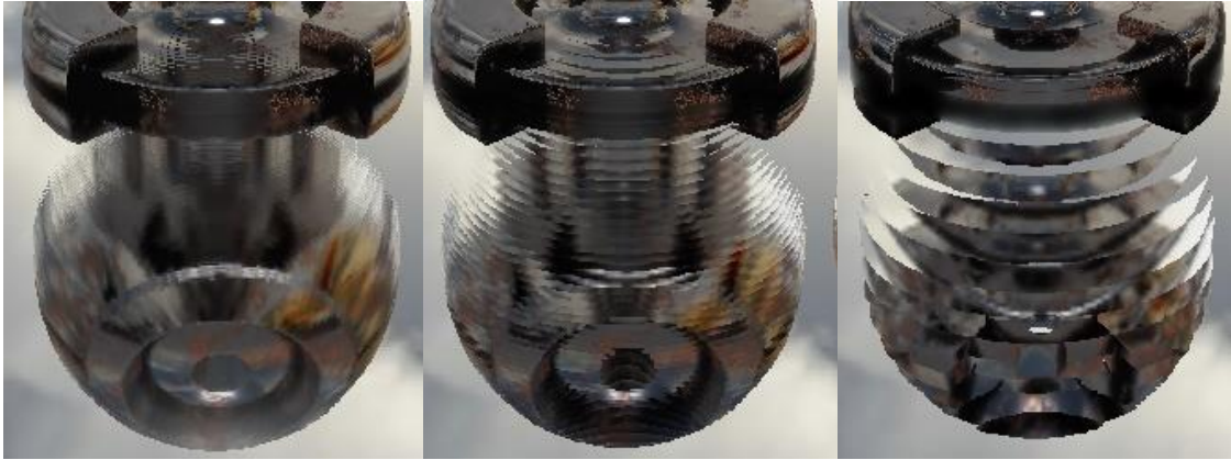
De gauche à droite : pixel stride à 1 (10.1ms), 8 (8.4ms), et 32 (6.5ms)
