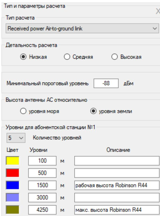
Рисунок 39. Мощность на приеме в направлении воздух-земля
