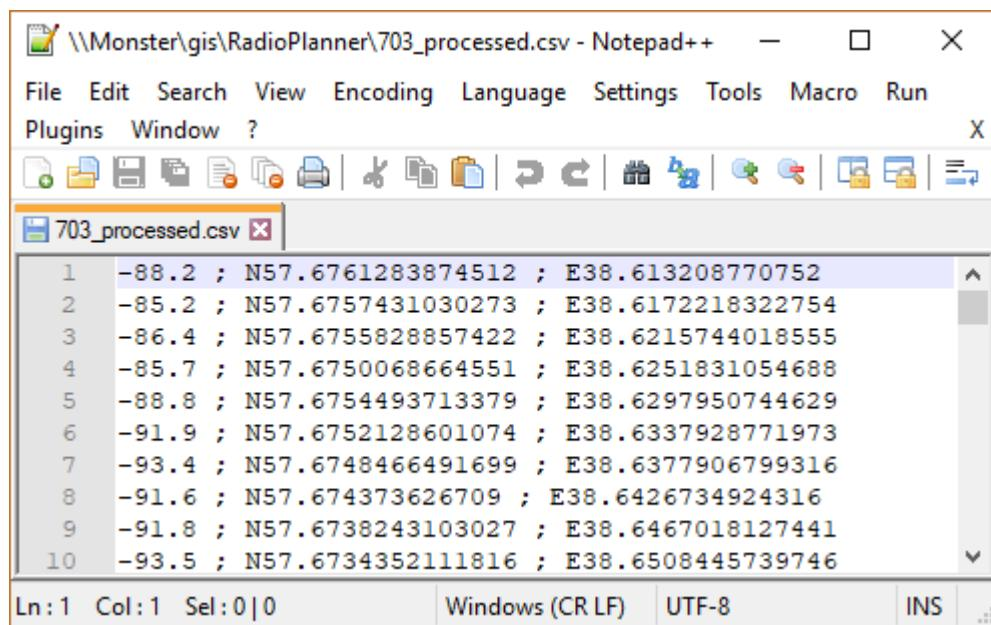
Рисунок 26. Пример файла с результатами измерений
