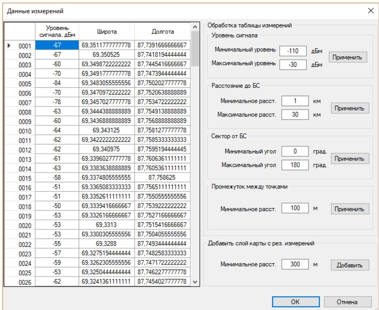
Рисунок 27. Предварительная обработка результатов измерений в секторе БС
