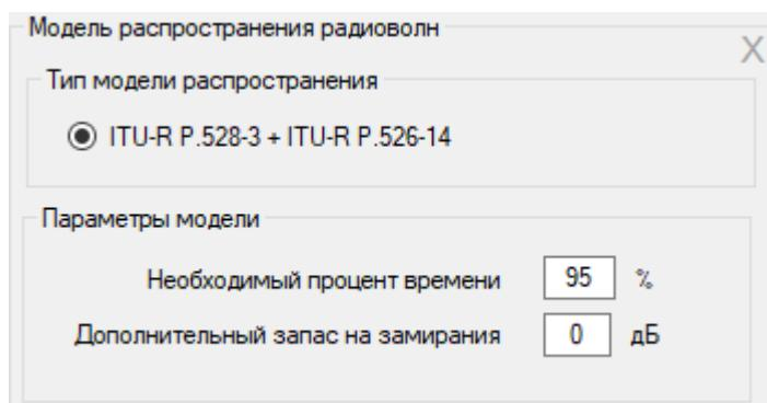
Рисунок 38. Меню “Модель распространения радиоволн” для проектов авиационная радиосвязь
