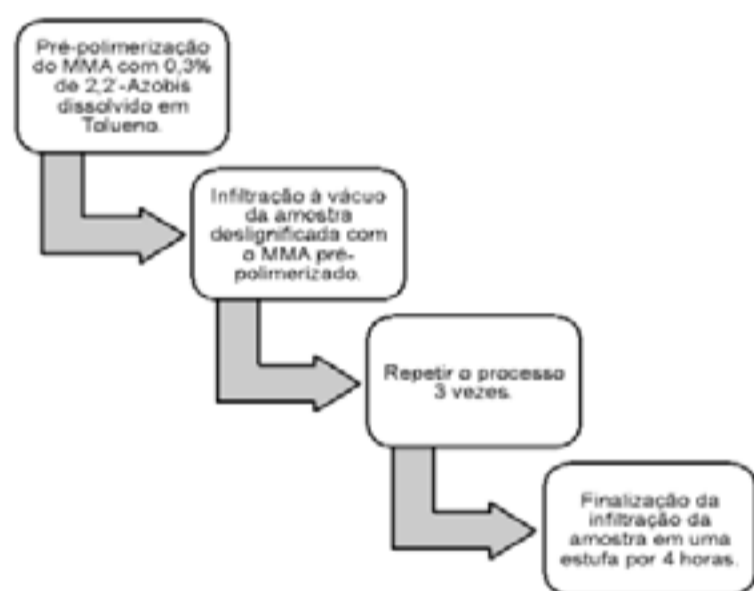
Figura 4 - Fabricação da Madeira Óptica Transparente.
