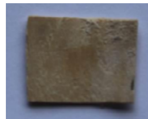
Figura 7: Amostra 01 com a camada de acrílico a luz solar.
