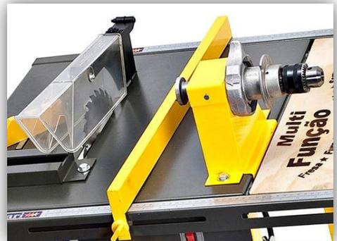
As funções **furadeira**, **esmeril** e **lixadeira de cinta** usam dispositivos acopláveis num encaixe universal. Apesar do acoplamento transmitir a potência do motor para a ferramenta, não há muitos recursos para o auxílio no uso. Diferente da furadeira de bancada vertical onde o motor desce através do acionamento de uma alavanca que permite o controle da profundidade do furo, nessa máquina a peça que se movimenta contra a broca sem acessórios para furação precisa.
