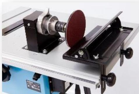
A **serra circular de bancada** possui uma mesa feita com chapa que pode apresentar imperfeições e empenamento. Além disso essas máquinas possuem apenas um rasgo para a guia de corte em ângulos o que dificulta a construção de gabaritos para cortes que usam dois rasgos paralelos.
