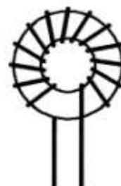
SPREAD THE TURNS EVENLY ON THE TOROIDS LEAVING A GAP BETWEEN START AND FINISH
