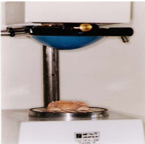
Figura 6- Lâmina de PVAc-PE aquecida com duas polegadas de curvatura.
