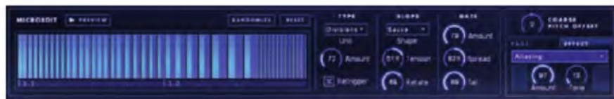
Figura 11 - Sezione Microedit con controlli per la regolazione della suddivisione dell'evento, regolazione del Gate, intonazione (Coarse Pitch Offset) e sezione dedicata ai Fade In-Out ed effetti. I singoli eventi possiedono regolazioni indipendenti del Microedit
