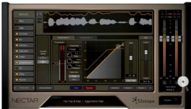
Figura 1 - Visualizzazione Advanced: la selezione del modulo visualizzato (compressore, in questo caso) avviene dalla colonna sinistra. Nella parte alta della finestra troviamo il display che mostra in tempo reale l'azione dell'effetto o lo spettro sonoro
