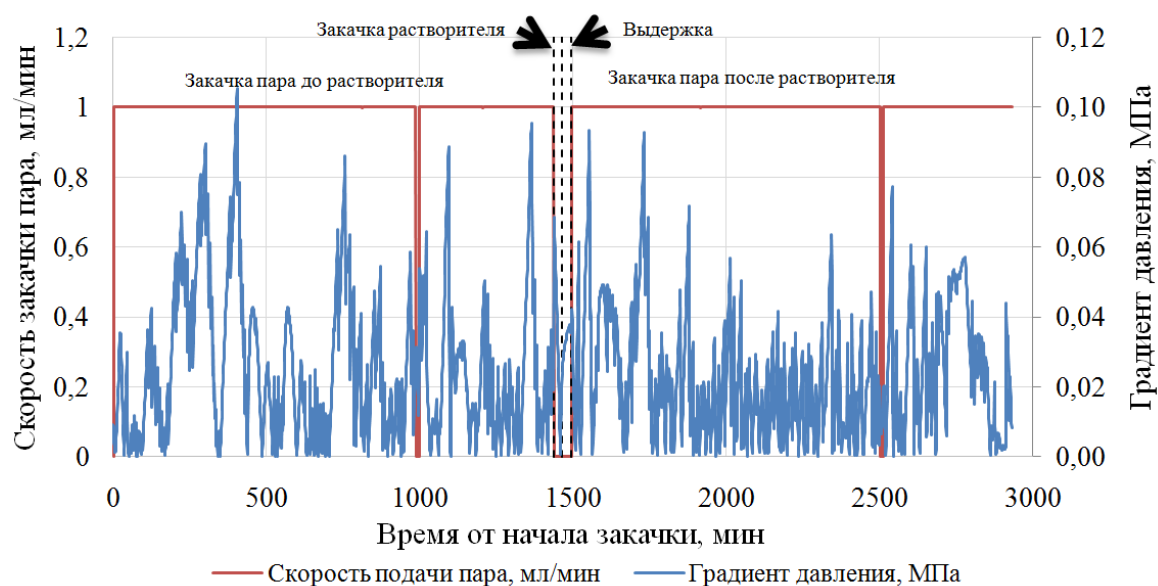
Рис. 4. Результаты регистрации данных с датчиков давления при закачке пара и композиции растворителя
