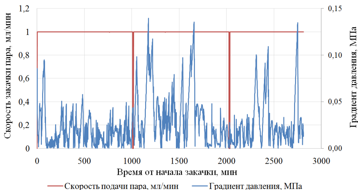
Рис. 3. Результаты регистрации данных с датчиков давления при закачке пара
