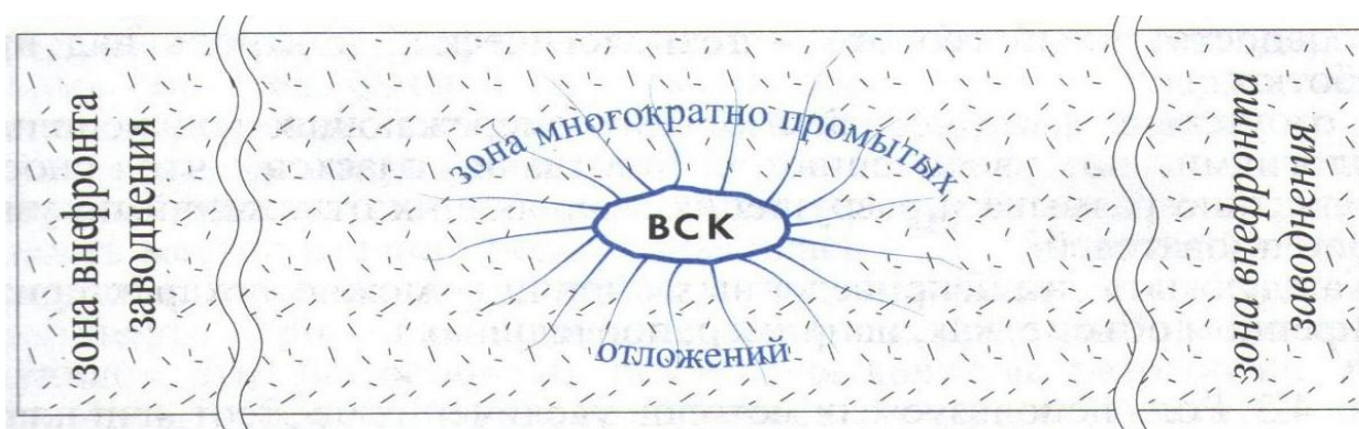
Рис. 7. Схематичный вертикальный разрез водосточного канала в недрах.
