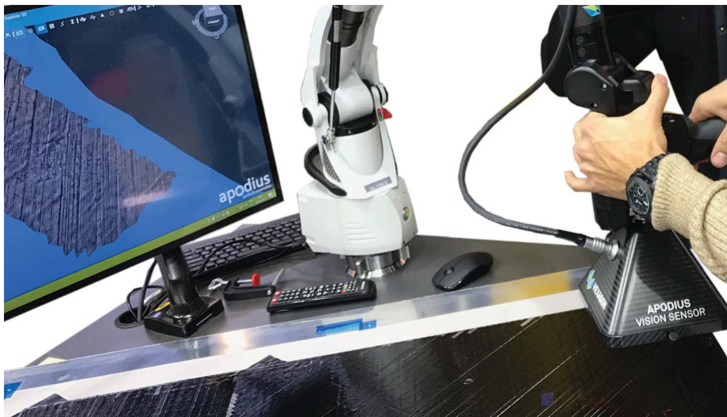
Figure 1 Système d'inspection automatisée et en temps réel de pièces d'avion en fibre de carbone
