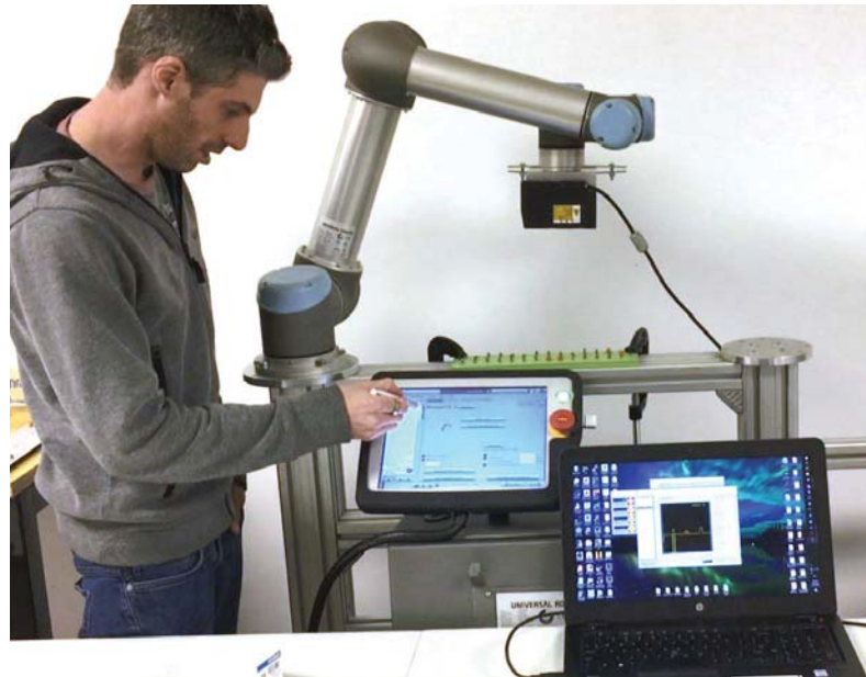
Figure 3 Développement d'une solution d'insertion automatisée de collets pour l'assemblage de composants d'avion
