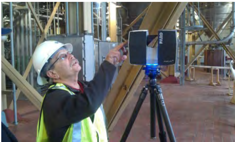
Figura 10 - CMDS, empresa da Califórnia, especializada em projetos, utilizando a tecnologia de digitalização a laser 3D da FARO. 17
