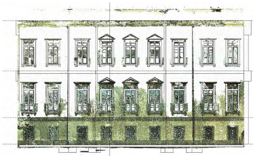
Figura 9 – Vista da nuvem de pontos e sobreposição no modelo 3D da fachada do Instituto Benjamin Constant - IBC. Escaner BRTech 3D. Acervo TECHNISCHE.
