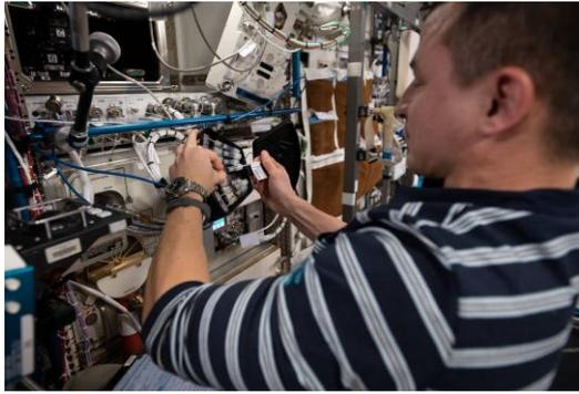
*L'astronaute Andrew Morgan, lors de l'expédition 60, manipulant le module d'expérimentation MVP (Multi-use Variable-g Platform) à bord de la Station Spatiale Internationale. Ce module permet de réaliser des expériences sur des petits organismes comme des cellules, des cristaux de protéines, des mouches et plantes. Crédits photo : NASA Images.*
