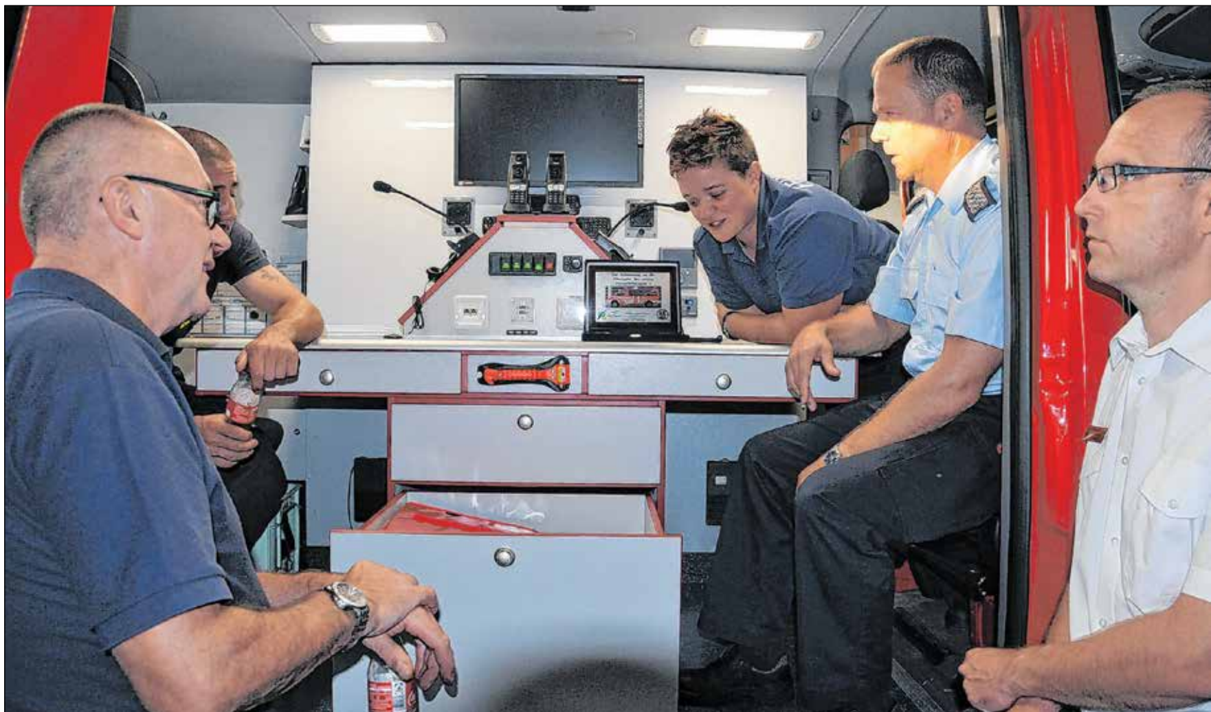
Ein fahrbares Büro: Der neue Einsatzleitwagen der Granseer Feuerwehr verfügt über modernste Kommunikationstechnik wie Digitalfunk, Internet, Multifunktionsdrucker mit Fax-Funktion und sogar eine eigene Internetadresse, wie hier gerade erklärt wird. Foto: Stephanie Fedders
