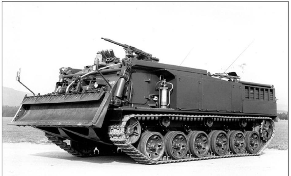
**Entpannungspanzer 65 (Prototyp)**
