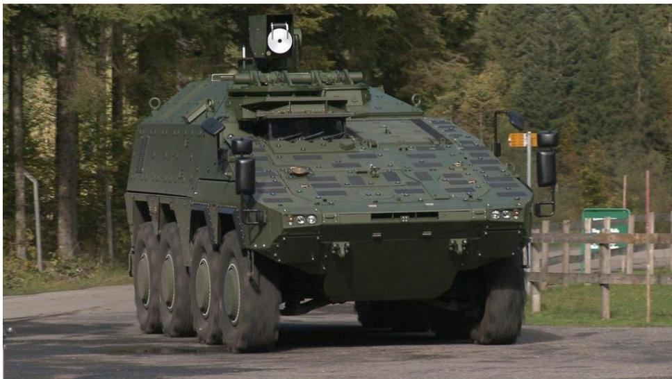
Bild: Demonstrator eines 5 kW-Festkörper-Lasers in einem BOXER (Fa. Rheinmetall).
