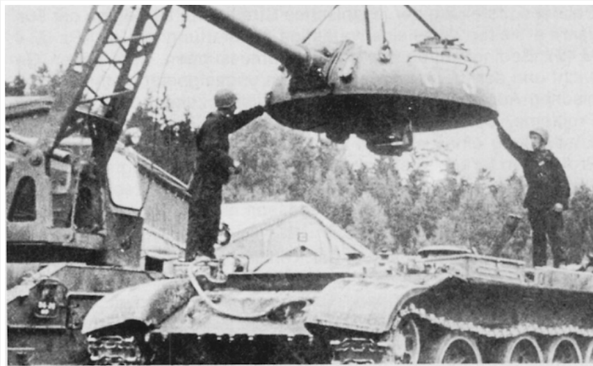
Bild 9: KPz T-54 bei der Feldinstandsetzung. Bemerkenswert ist die einfache Turmkonstruktion (ohne Turmkorb); durch die schmale Blende ist ein Waffenausbau nach vorn nicht möglich.
