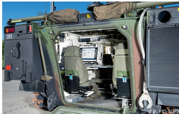
Ein mit FIS HEER ausgerüsteter Kommandoschützenpanzer 2000.
