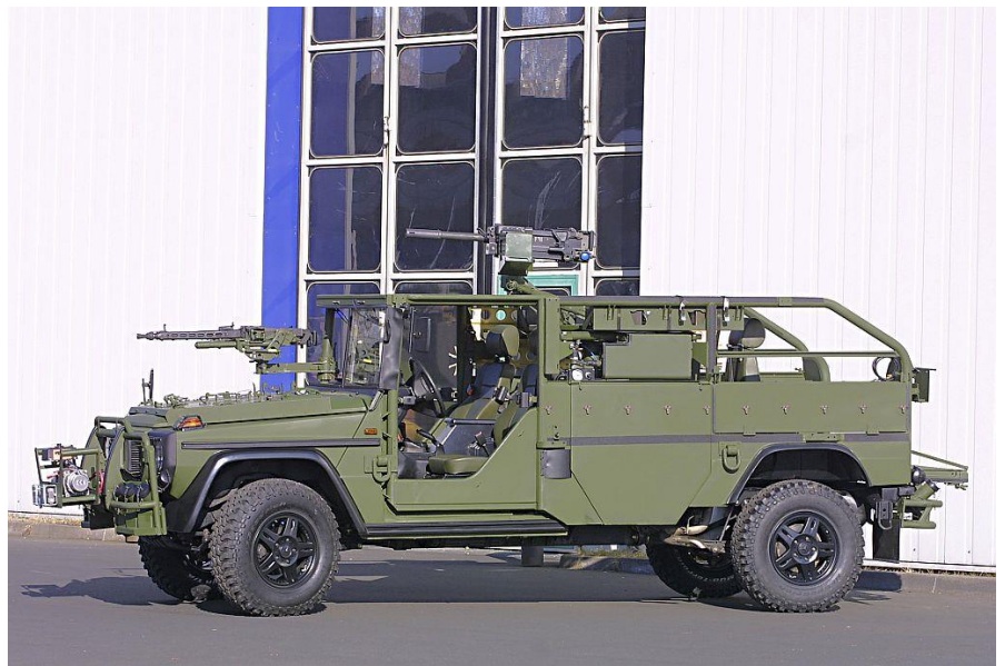
Rheinmetall Serval, beim AAD 10 eingeführt als Leichtes Aufklärungsfahrzeug LAUF (Quelle: Bundeswehr)
