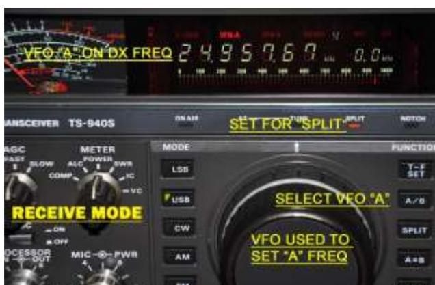
Para facilitar, aperte a tecla A=B para que o VFO B fique na mesma frequência da estação DX. Isso o deixará próximo da frequência que irá transmitir sem ter mexer muito no rádio. Aperte a tecla SPLIT e siga as imagens.
