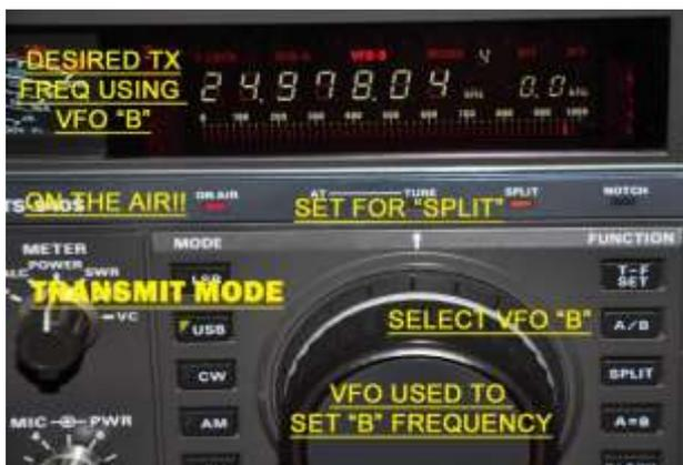
Porém, a configuração mais desejável, é ter um rádio com um segundo receptor (*sub-receiver*). Isso lhe permitirá ouvir a frequência da estação DX, transmitir na frequência em que ela ouve, e também ouvir na frequência que você transmite.
