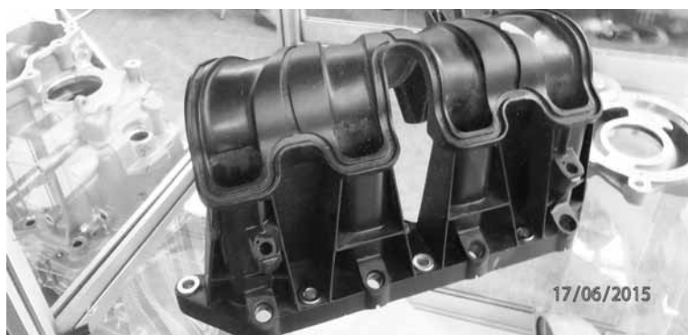
Рис. 3. Впускной коллектор с компонентами из углеволокна на 3,5-литровый двигатель для гоночного автомобиля Ford, напечатанный на 3D-принтере
