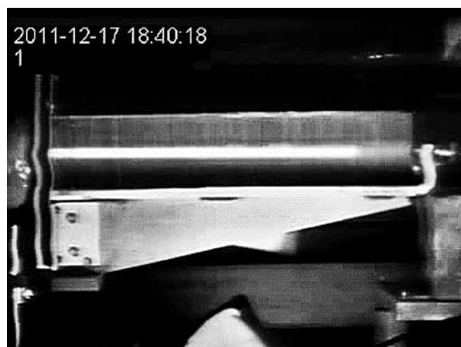
Рис. 7. Пучок ионов углерода, выведенный из У-70, останавливается в блоке сцинтиллятора. Полная толщина сцинтиллятора – 400 мм
