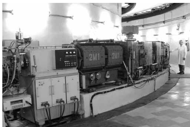
Рис. 4. Быстроциклирующий протонный синхротрон – бустер У-1,5
