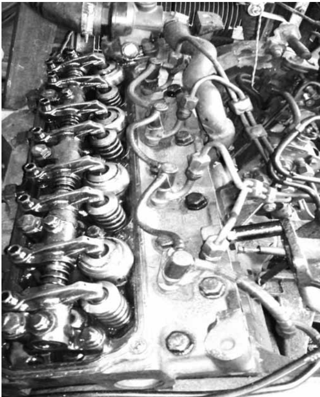
Рис. 3. Дизель с модернизированной системой газораспределения на испытательном стенде
