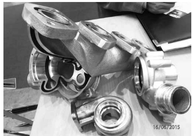
Рис. 2. Совместно отлитые охлаждаемые коллектор впуска/выпуска с корпусом компрессора/турбины соответственно
