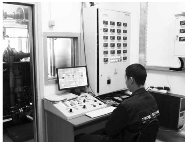
Рис. 4. Стенды для испытаний агрегатов наддува
