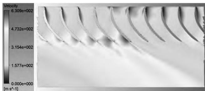
**Рис. 5.** Поле распределения скорости в сечении 50% по высоте лопатки
