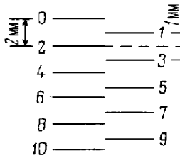
Рис. 29. Шкала для определения цены деления барабана в полевых условиях
