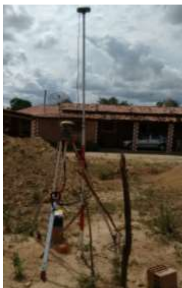
Figura 4 – Rastreio com receptor GNSS.
