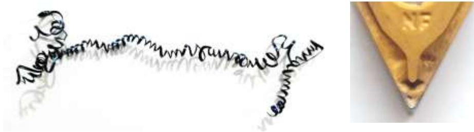
Şekil 3.1. Deney No 1: 0,12 mm/dev ilerleme için talaş ve kesici takım görüntüsü
