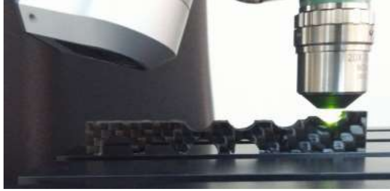
Şekil 5. Yüzey pürüzlülüğü ( R_a ) ölçümü
