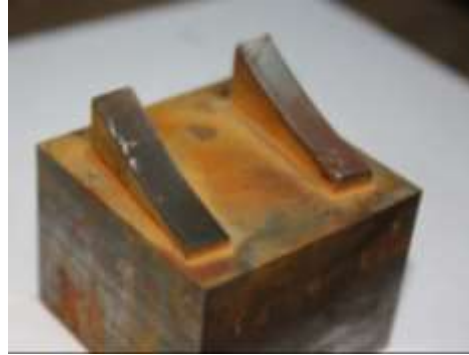
Şekil 16: Aparat 4 ile işlenmiş anot (sol).
