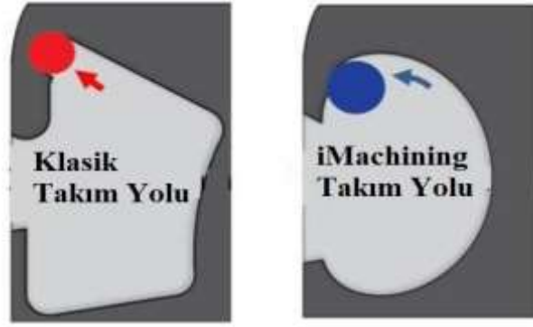
Şekil 3: Geleneksel ve iMachining takım yolu [14]
