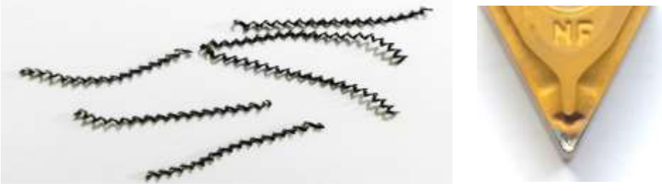
Şekil 3.2 Deney No 5: 0,22 mm/dev ilerleme için talaş ve kesici takım görüntüsü
