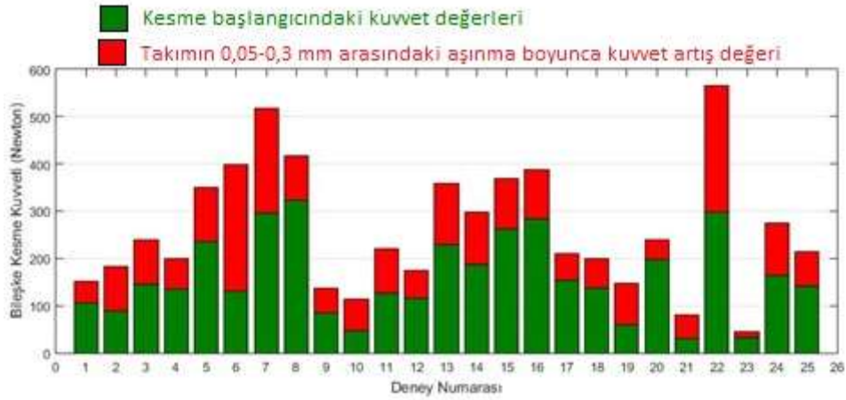
Şekil 4. Serbest Yüzey Aşınma miktarı 0,05~0,3 mm arasındaki FR kesme kuvvetleri
