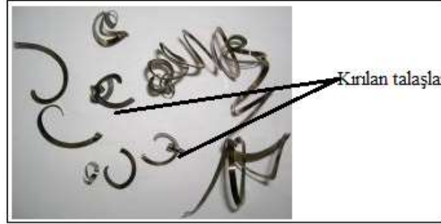
Şekil 8. AISI4140 kaba tornalamada değişken ilerleme aralığında elde edilen talaşlar (f= 0,30-0,40 mm/dev)
