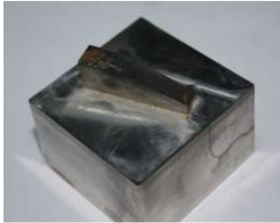
Şekil 10: Kısa devre oluşumu ile zarar görmüş katot.
