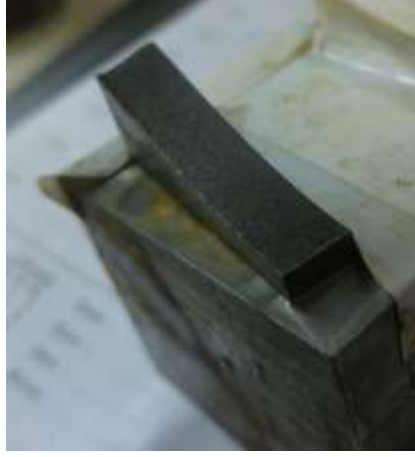
Şekil 18: Oksit katmanı oluşmuş yüzey.
