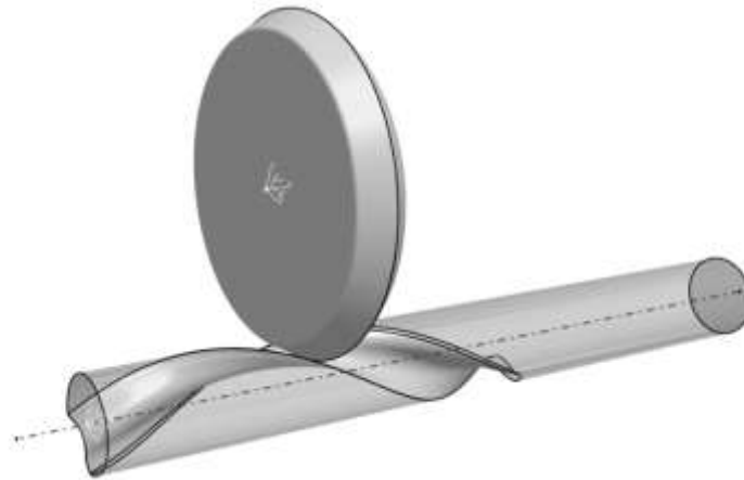
Şekil 3. Kanal geometrisinin oluşturulması
