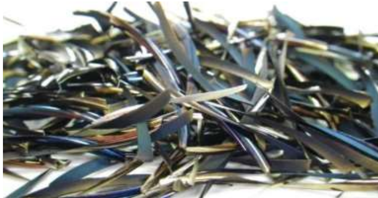
Şekil 7: iMachining stratejisi ile oluşan talaşlar
