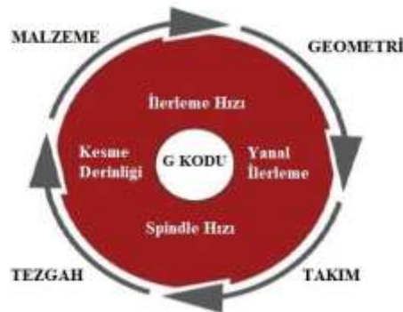
Şekil 5: iMachining için gerekli teknolojik bilgiler [11]
