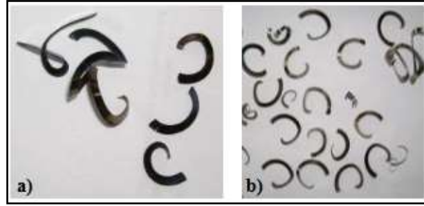
Şekil 5. AISI4140 malzemesinin kaba ve ince tornalanmasında kırılan talaşlar a)11.deney b)15.deney
