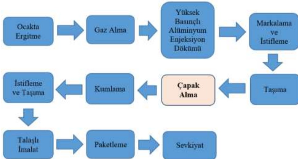
Şekil 1: İncelenen parça için akış şeması
