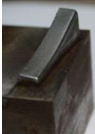
Şekil 19: Açık sistem elektrolit transferi ile işlenmiş anot yüzeyi.
