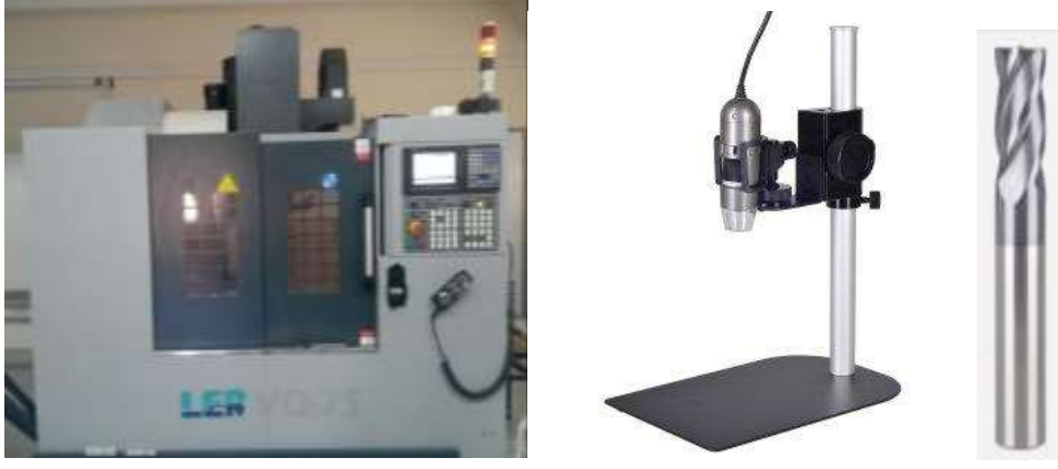
Şekil 10: LER VQ 75 CNC işleme merkezi, Dyno-Lite Pro2 mikroskop ve HTG parmak freze
