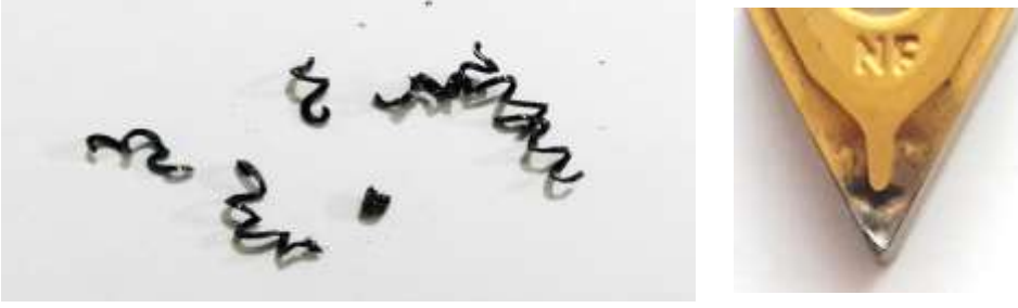
Şekil 3.3 Deney No 9: 0,32 mm/dev ilerleme için talaş ve kesici takım görüntüsü
