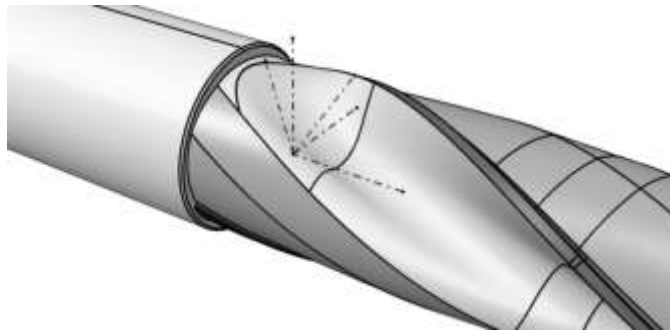
Şekil 7. Kanal modelleme: çıkış formu dönme ekseninin belirlenmesi
