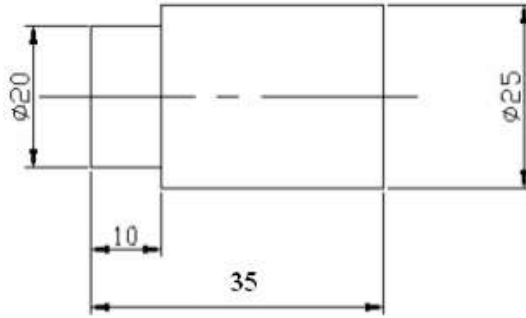
Şekil 1. Deneylerde kullanılan numunelere ait teknik resimler.
