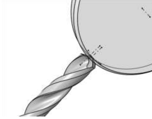
Şekil 15. Taşlama taşı matkap splitinin başlangıç noktasında konumlanması
