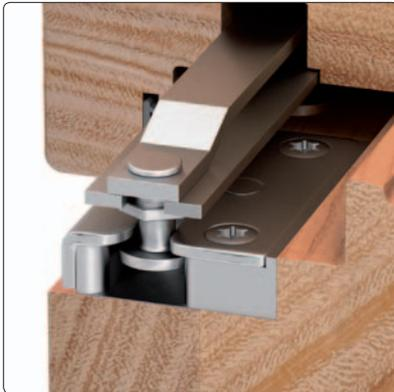
Der einseitig gehärtete Pilzkopfbolzen verhakt sich sicher im Schließteil. Aushebeln ist im verriegelten Zustand fast unmöglich.
