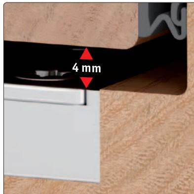
Die auf 4 mm reduzierte Falzluft\* erfordert höchste Präzision in der Herstellung der Elemente und lässt dem Täter nur wenig Spielraum.
