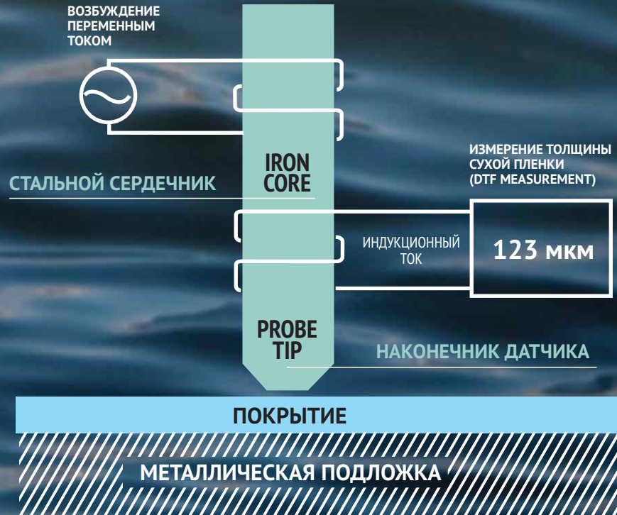
Рис. 1. Принцип действия современного толщиномера
