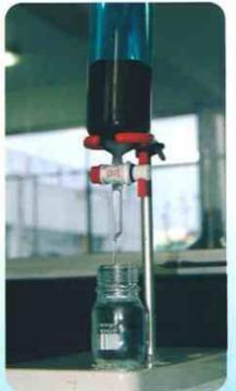
Disposición del material adsorbente en un sistema de filtrado en laboratorio
