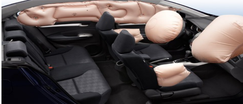
Alguns tipos de airbags: Motorista, Passageiro, Lateral e Cortina
