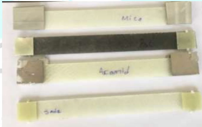
Şekil 4. ASTM 3039 standartlarına göre kesilen kompozit numuneler
