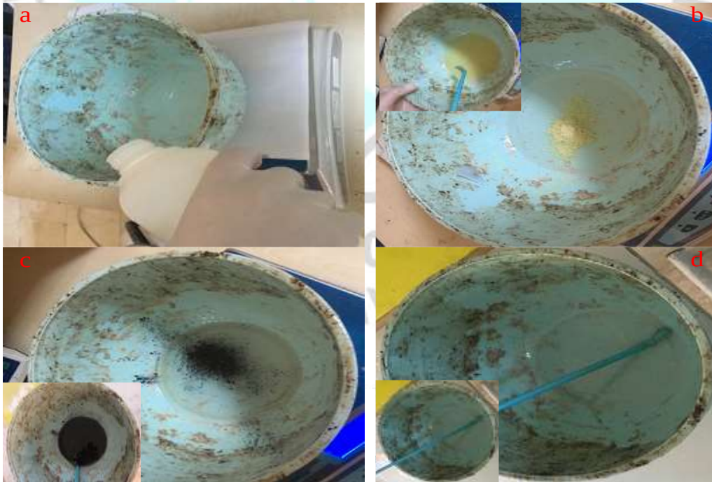
Şekil 2. a) sade epoksi, b) aramid+epoksi, c) bor karbür+epoksi ve d) mika+epoksi bileşenlerin ölçümü ve karıştırma sonrası gösterileri
