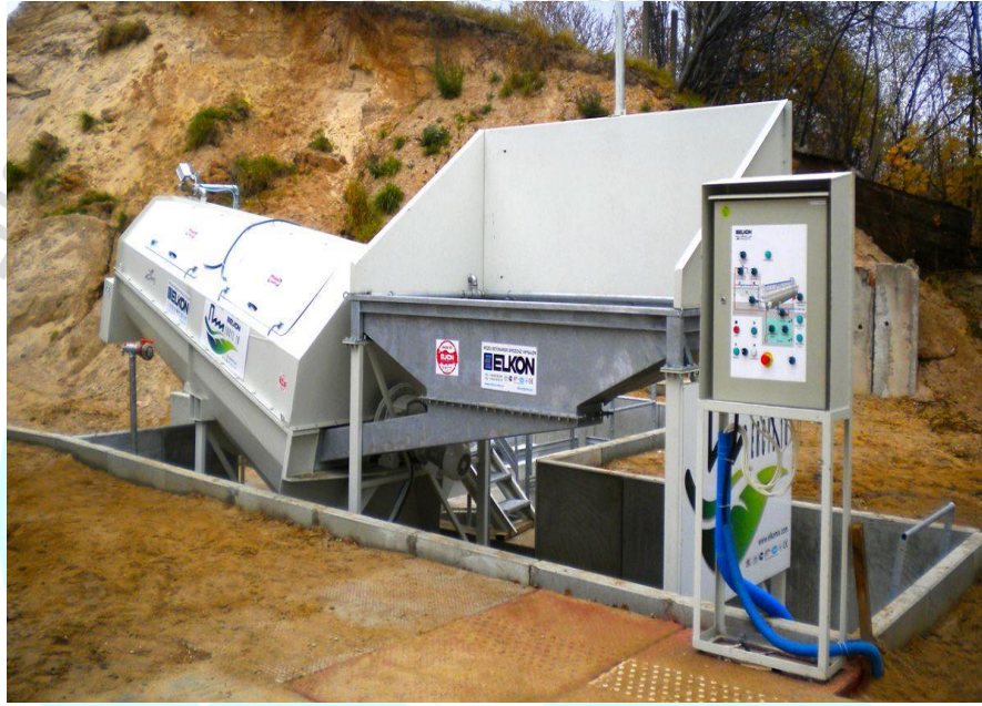
Şekil 2. Bir beton geri dönüşüm tesisi
