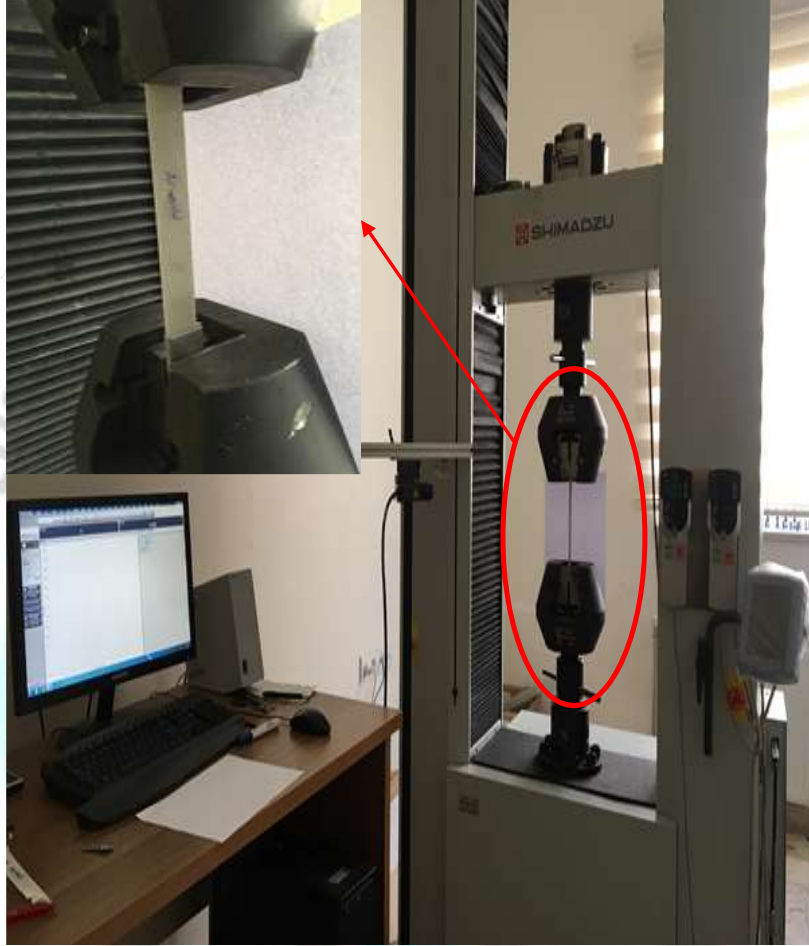
Şekil 5. Çekme deneylerin yapıldığı SHIMADZU marka çekme cihazı
