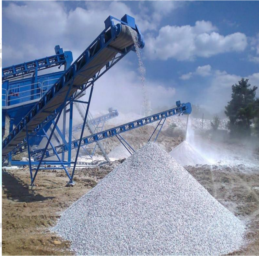
Şekil 3. Bir mermer atığı geri dönüşüm santrali
