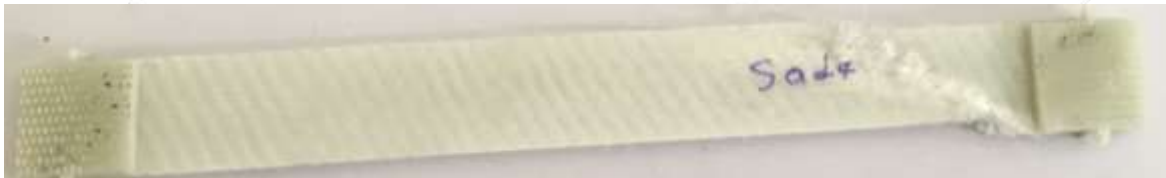
Şekil 6. Çekme testleri neticesinde hasara uğramış numune
