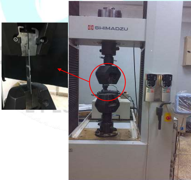
Şekil 2.6. Çekme deneylerin yapıldığı SHIMADZU marka çekme cihazı
