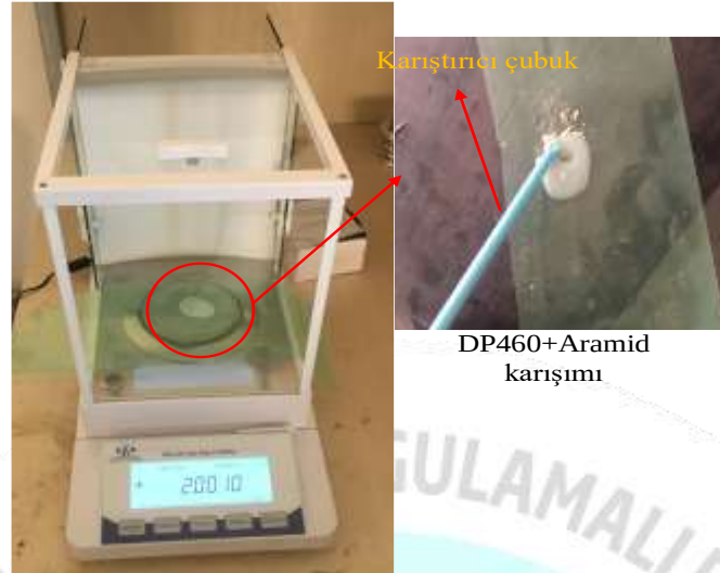
Şekil 2.5 DP460 ve Aramid karışımının hazırlanışı
