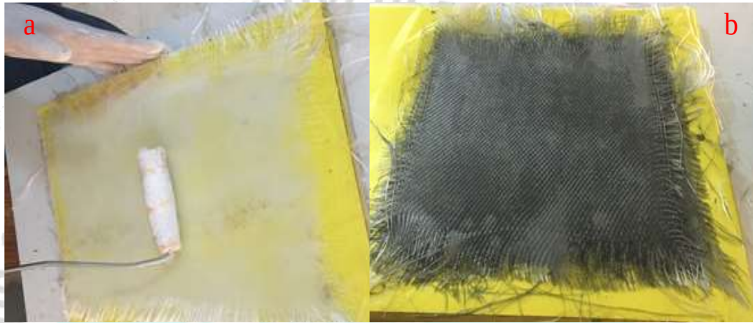
Şekil 3. Elle yatırma yöntemi ile kompozit malzeme üretim işlemi, (a-Mika, b-Bor karbür)
