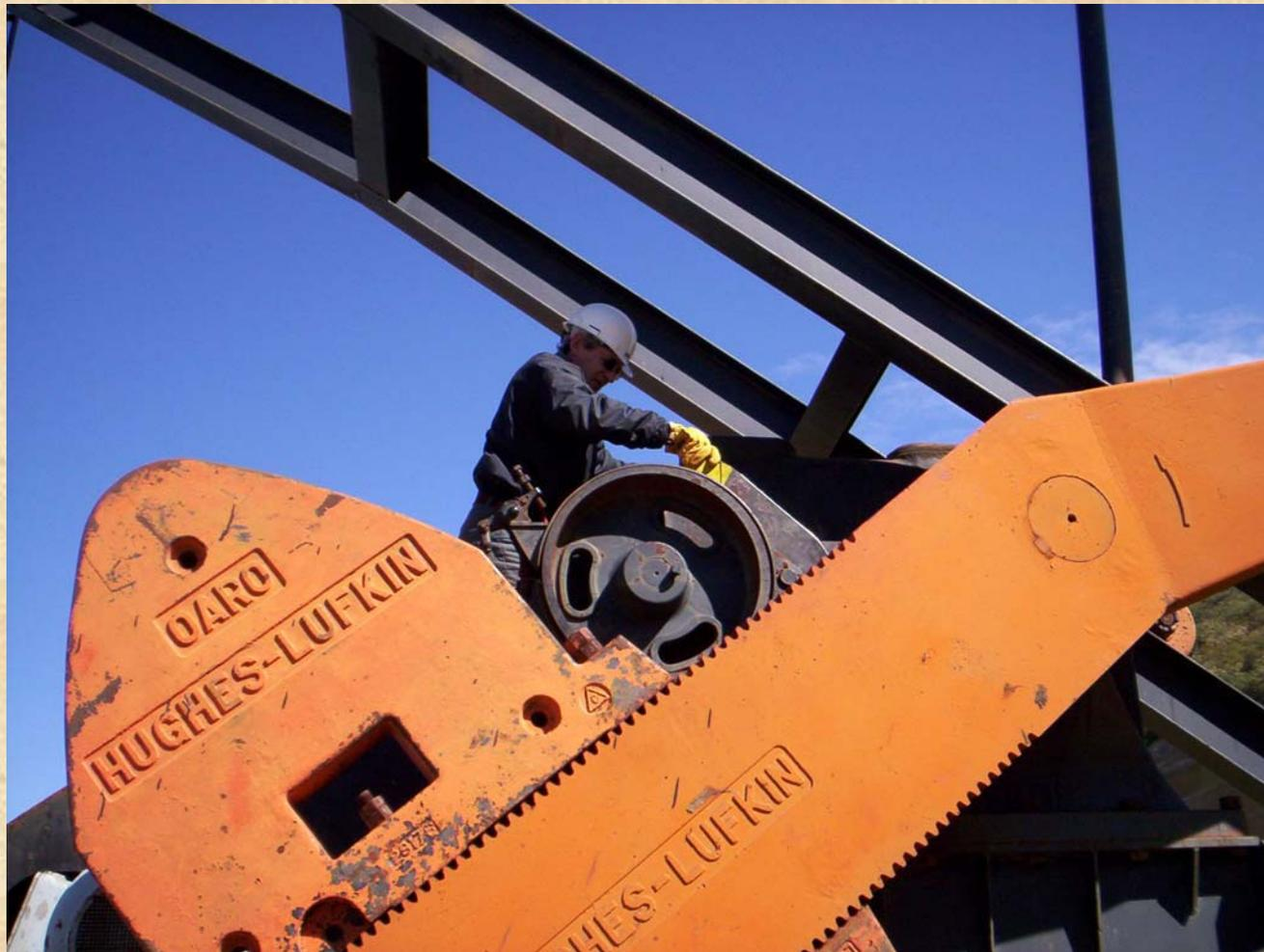
*Luego de haber colocado la traba de seguridad realiza el camino inverso hasta salir de la estructura del AIB a fin de que se realicen las tareas surgidas a tal fin.*
