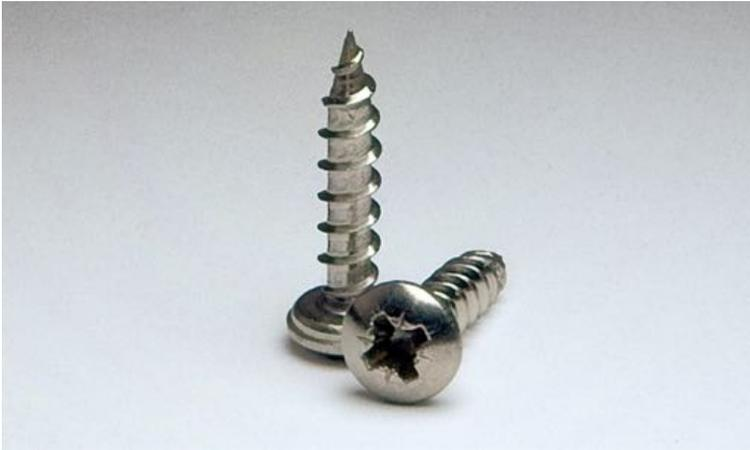
Unsere Edelstahlschrauben sind nach DIN 7981 hergestellt. Sie dienen zur Montage der Fensterbank an den Fensterrahmen. Edelstahlschrauben bieten wir mit einer Stärke von 3,9 mm und einer Länge von 19 (Standard) bzw. 25 mm an.
