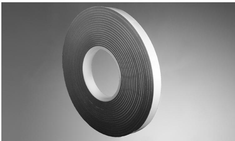
Fugendichtband wird als Dehnungsausgleich zwischen Fensterbank-Abschluss bzw. Unterseite der Fensterbank und Mauerwerk bzw. WDVS\*-Aufbau eingesetzt.
