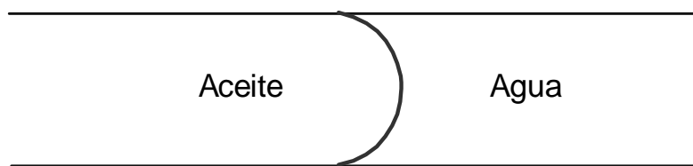
Fig. 2.29.b. Principio de la presión capilar
