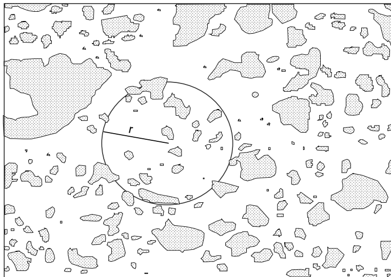
Fig. 2.3. Muestra de roca para distribución de porosidad
