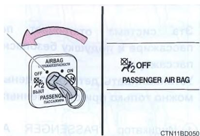
Автомобили с интеллектуальной системой доступа без ключа: Вставьте механический ключ в цилиндр и поверните его в положение "OFF".
