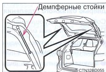
**■ Стержни двери багажного отделения (автомобили с электромеханической дверью багажного отделения)**
