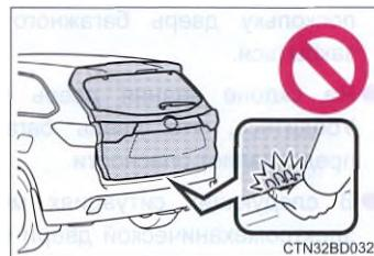
● Будьте осторожны при использовании привода закрывания двери багажного отделения, т.к. он все еще работает, когда система электромеханической двери багажного отделения отключена.
