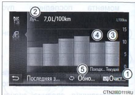
Журнал среднего расхода топлива делится по цвету на предыдущие средние значения и средний расход топлива с момента последнего обновления. Используйте отображаемый средний расход топлива в качестве справочной информации.
