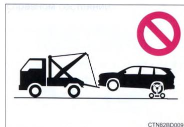
**Буксировка на эвакуаторе с частичной погрузкой**
