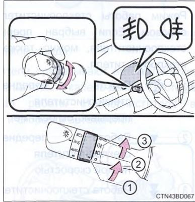
Еще раз повернув кольцо переключателя, можно выключить только задний противотуманный фонарь.
