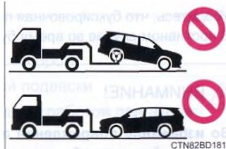
Полноприводные модели: Обязательно транспортируйте автомобиль со всеми четырьмя колесами над землей. Если автомобиль буксируется, а его колеса касаются земли, трансмиссия может быть повреждена, а сам автомобиль может упасть с эвакуатора.
