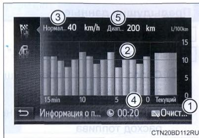
Автомобили без интеллектуальной системы доступа без ключа: Средний расход топлива за последние 15 минут делится по цвету на предыдущие средние значения и средние значения с момента последнего поворота кнопки запуска двигателя в положение "ON". Используйте отображаемый средний расход топлива в качестве справочной информации.
