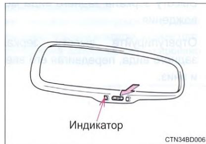
Когда функция автоматического затемнения находится в режиме ON, индикатор загорится.
