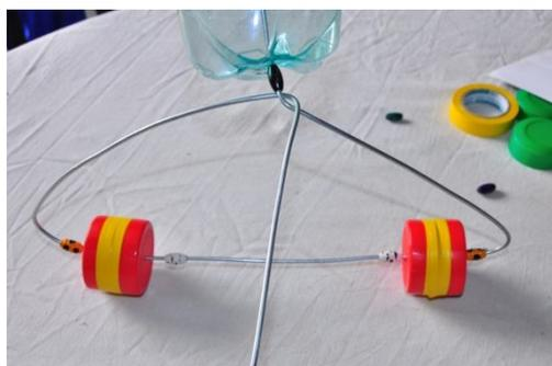
Tordre le fil de fer de façon à obtenir la bouteille centrée. Faites un angle de 90 autour de l'autre partie du fil. Voir la photo ci contre.
