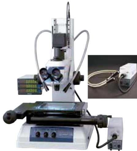
A: Iluminación Vertical de Superficie (Halógena)
