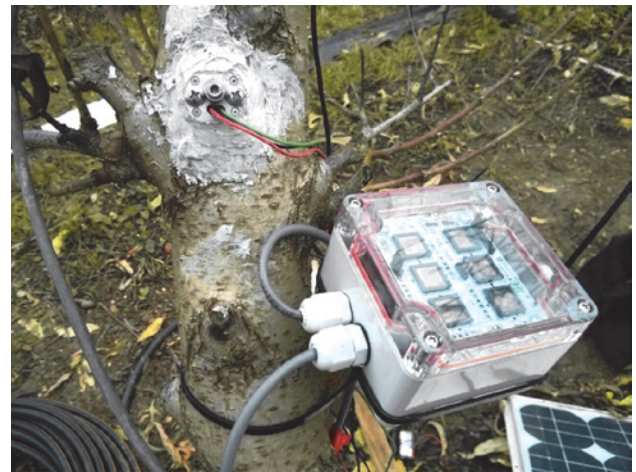
תמונה 2: חיישן SWP מותקן באפרסק, חווה ניסויית החולה, יחד עם משדר אלחוטי להעברת התוצאות לעיבוד מרחוק
