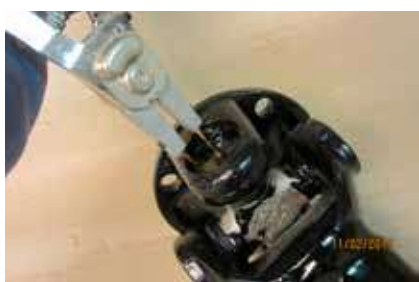
Afmonter alle låseringe
