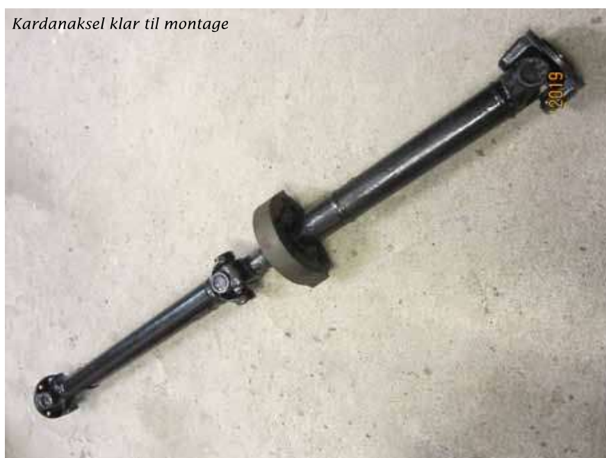
Slå evt på enderne med lejeskålene for at sikre korrekt anløb
