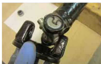
Lirk kardanflange på plads på kryds
