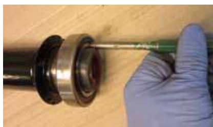
Montér nyt midterleje
