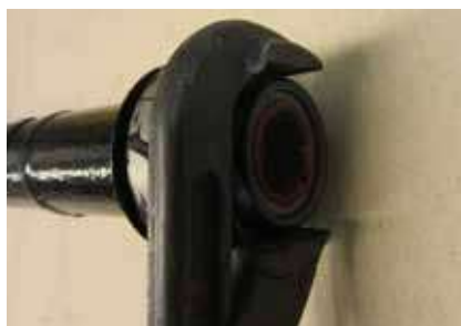
Demontér midterlejets møtrik
