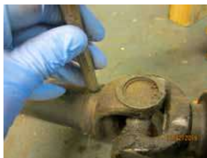
Mærk op for korrekt genmontering
