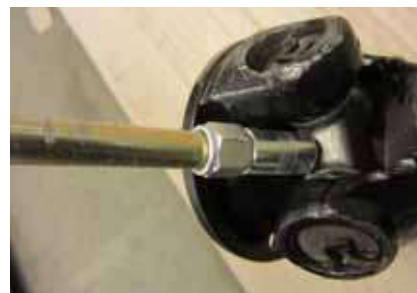
Montér smørenipler og smør med fedt
