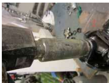
Slå evt på enderne med lejeskålene for at sikre korrekt anløb
