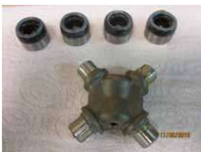
Demontér lejeskåle fra det nye kryds
