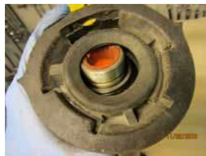
Montér nyt midterlejegummi
