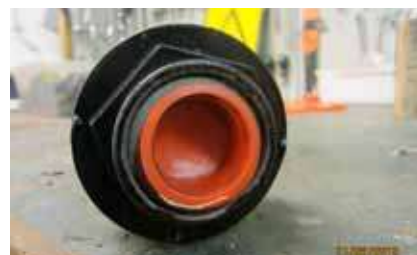
Prop i glidelejet til inden sandblæsning
