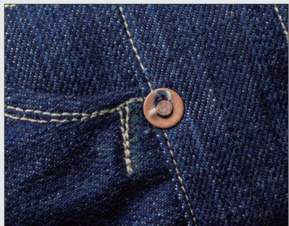
叩き潰した銅製リベット。
