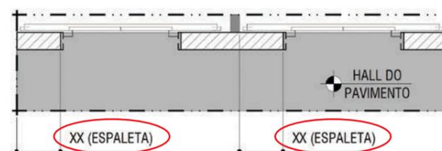
Planta da face frontal de duas caixas de elevador adjacentes. A medida XX representa a medida da espaleta (largura da alvenaria ao lado da porta de pavimento). Esta medida é indicada somente na Planta de Instalação dos Elevadores pela Atlas Schindler.
