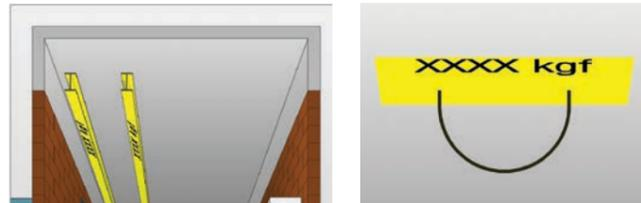
Imagens ilustrativas que exemplificam a sinalização obrigatória nas vigas e ganchos, a cargo da Construtora.
