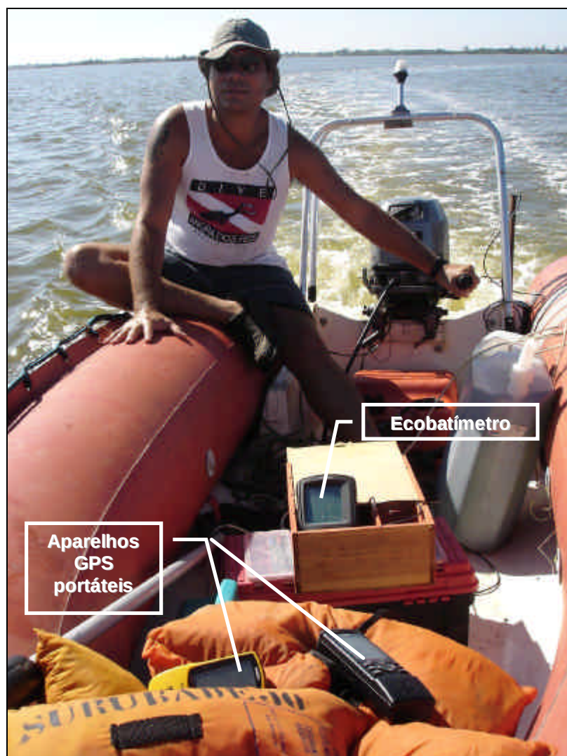
Figura 5: barco equipado com motor de 25 HP e equipamentos utilizados no levantamento batimétrico
