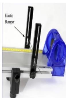
Figura 10.2: Sensor de movimiento y parachoques elástico.
