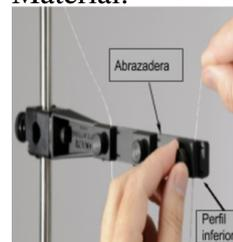
Figura 2.4: Colgando el contrapeso en la abrazadera del péndulo.
