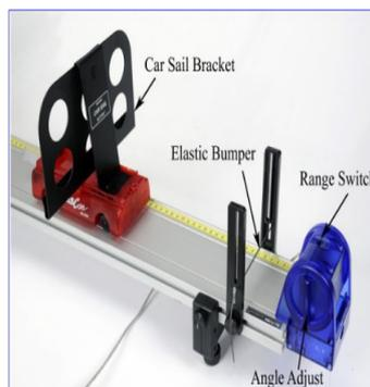
Figura 4.3: Sensor de movimiento en la pista.
