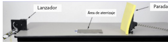
Figura 12.1: Lanzamiento del proyectil desde la altura de la mesa.
