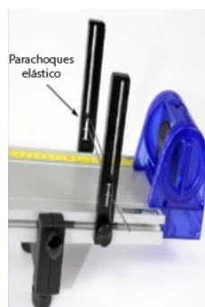
Figura 11.2: Sensor de movimiento y parachoques elástico.
