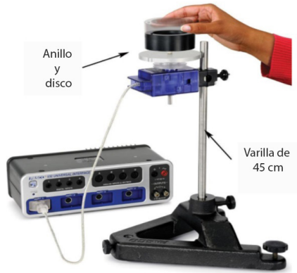
Figura 21.1: El momento angular inicial se compara con el momento angular final, y la energía cinética inicial se compara con la energía cinética final
