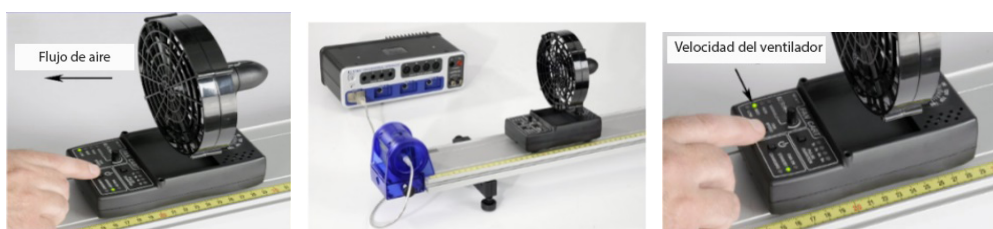
(a) Encendido del ventilador. (b) Movimiento del carro con ventilador. (c) Ajustar la velocidad del ventilador.
