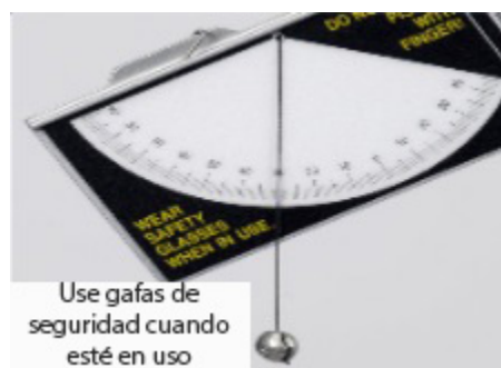
Figura 12.3: Ajuste del ángulo de lanzamiento.
