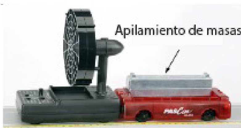
(b) Carro con ventilador empujando al PAS-CAR
