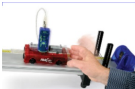
Figura 10.5: Conexión del sensor de aceleración y el carro.
