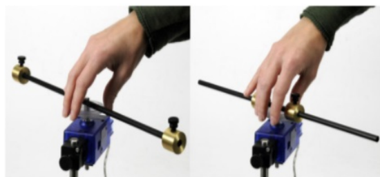
Figura 18.3: Masa en radio grande y en radio pequeño
