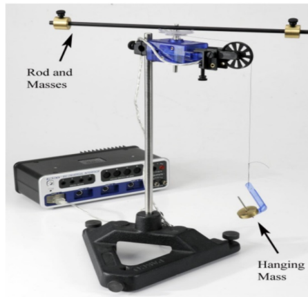
Figura 18.1: La masa que cuelga aplica una torca al eje del sensor de giro y la aceleración angular resultante de la varilla y el peso de las masas de latón se investiga
