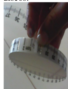
Figura 3.1: Kit para medir diámetro y perímetro de 4 discos.
