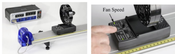
(a) Movimiento del carro con ventilador. (b) Ajustar la velocidad del ventilador.
