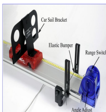
Figura 4.3: Sensor de movimiento en la pista.
