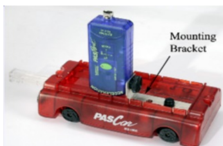
Figura 10.3: Conexión del sensor de movimiento y el carro.
