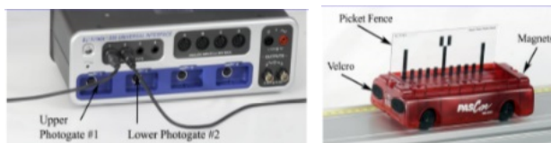
(a) Conexiones de las 'Photogate' al 850
