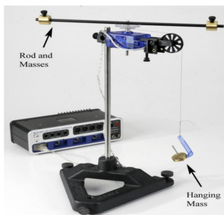
Figura 18.1: La masa que cuelga aplica un torque al eje del sensor de giro y la aceleración angular resultante de la varilla y el peso de las masas de latón se investiga
