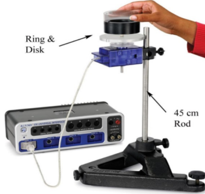
Figura 19.1: El momento angular inicial se compara con el momento angular final, y la energía cinética inicial se compara con la energía cinética final
