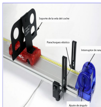
Figura 5.4: Sensor de movimiento en la pista.
