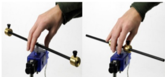
Figura 19.3: Masa en radio grande y en radio pequeño
