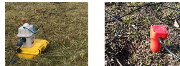
2. ábra: Terepi adatgyűjtő (bal oldal) és geofon (jobb oldal)
