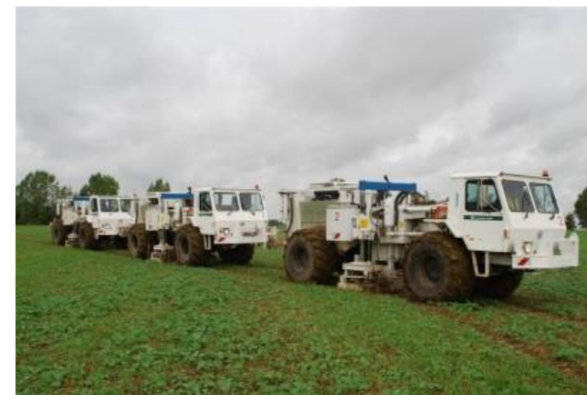
3. ábra: Munkatársaink ilyen önjáró vibrátor járművekkel keltenek majd mesterséges rezgéseket
