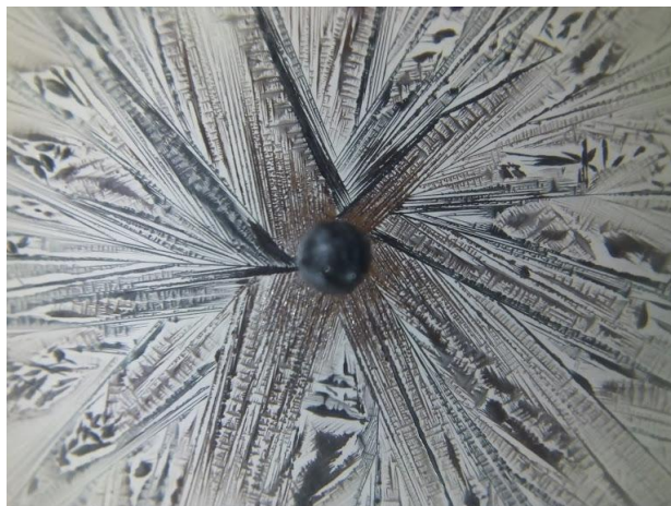
Figura 2: Imagem da recristalização do iodo em acetona
