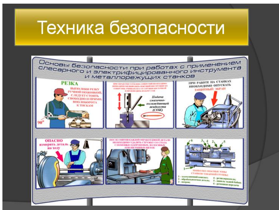
Рис.3. Техника безопасности при работе за станком
